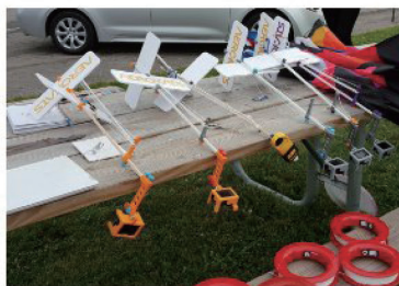
(C) 航空浮槳的一端是交叉的浮板，另一端則承載觀測儀器，左起第三支浮槳的前端負載著無線氣象儀(黃色)。
