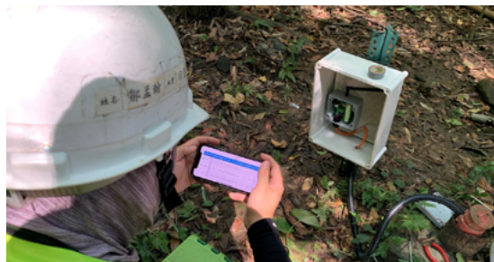
圖 11. VWdot 儀器安裝及網頁連線設定 (陸島工程顧問 (股) 公司提供照片)
