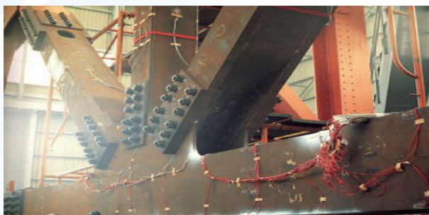
▲ 圖18 橋梁或鋼構應力檢測
