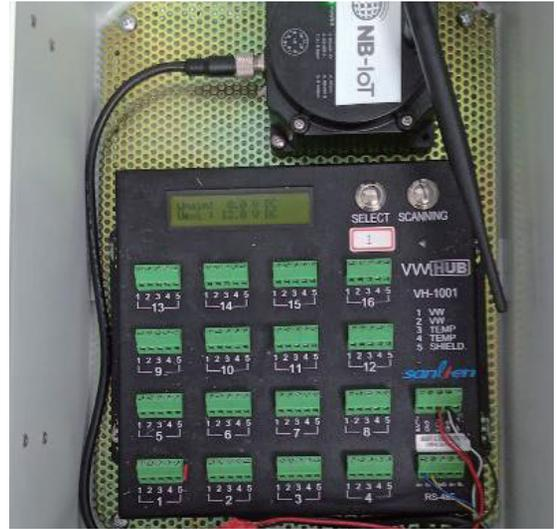
圖 17. NB-IoT 結合 VW HUB 系統傳輸
