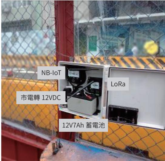
圖 16. NB-IoT 結合 LoRa 系統傳輸
