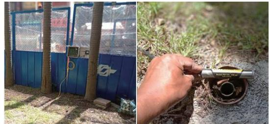
圖 22. 結合 LoRa 模組振弦感測器掃描箱
