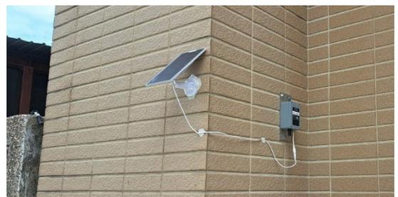
圖 8. 電子式傾斜計
