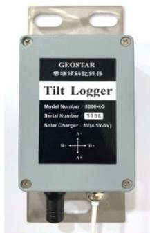
圖 5. 電子式傾斜計
