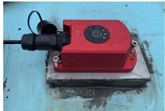
▲ 圖7 MEMS加速度計
