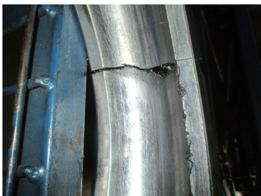
▲ 圖11 軸承外圈斷裂
