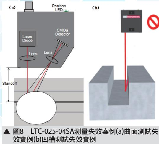
▲ 圖8 LTC-025-04SA測量失效案例(a)曲面測試失效實例(b)凹槽測試失效實例
