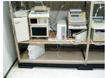
▲隔震架設完成高架櫃
