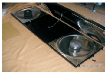
▲組裝隔震裝置
