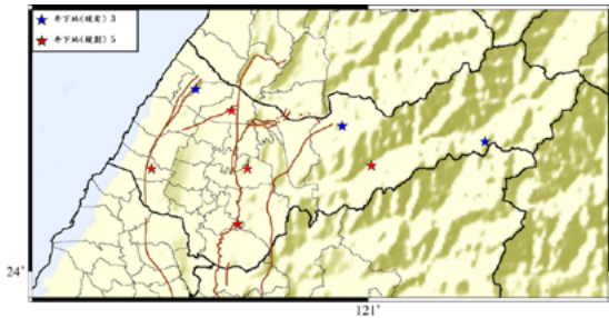
圖 10. 都會區強震預警精進計畫下建置新井下地震儀規劃，111-113 年中區預計新增 5 站 [2] 。
