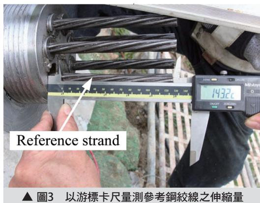
▲ 圖3 以游標卡尺量測參考鋼絞線之伸縮量
