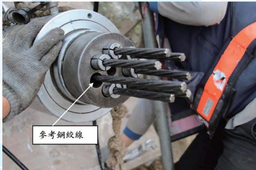
▲ 圖6 不上夾條片鋼絞線之現地拉力試驗時之伸張情況(拉力減少)
