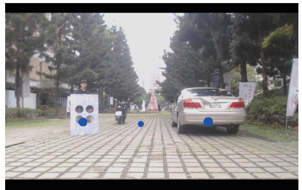
圖 3-a. 相機 - 光達 - 雷達映射資訊 - 雷達投影至影像
