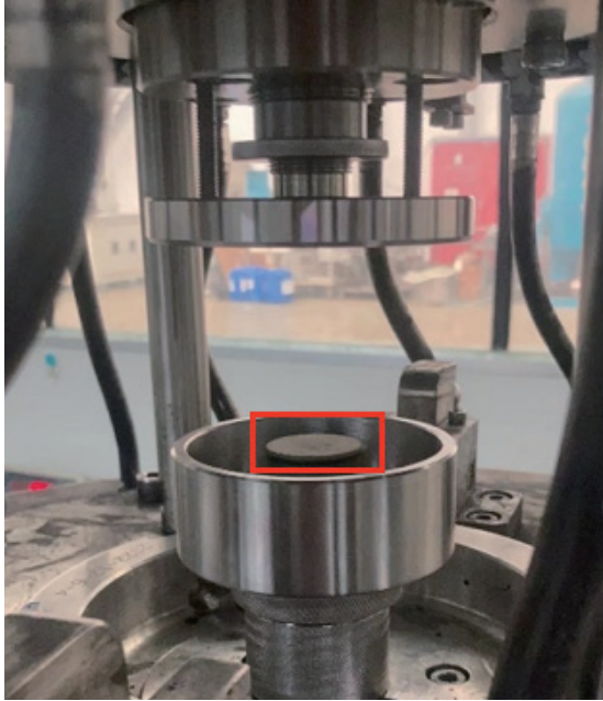
圖 5. 電渦流安裝位置 (作者實物拍攝)
