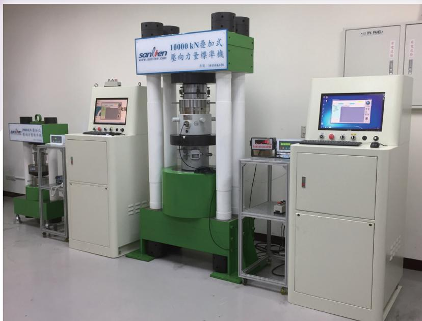
10000kN & 2000kN 疊加式壓向力量標準機
