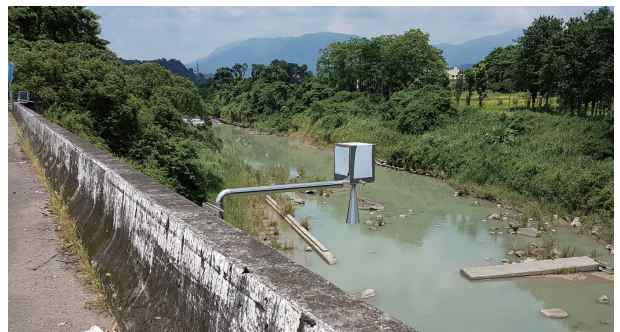
▲ 圖3 雷達波水位計裝設於義仁橋位置
