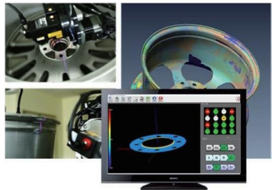
汽車輪圈掃描量測
