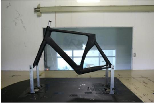
圖 8 車架風洞實驗
