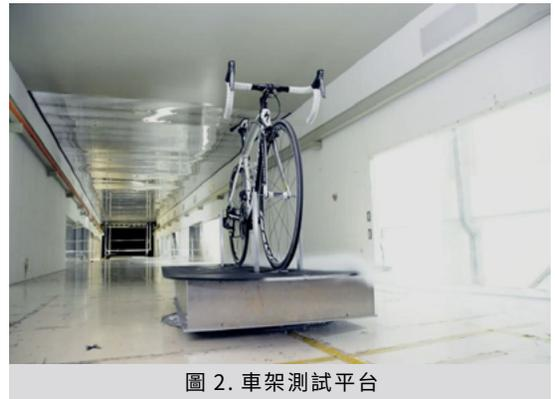
圖 2. 車架測試平台
