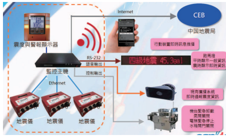
圖 3. 現地預警系統架構
