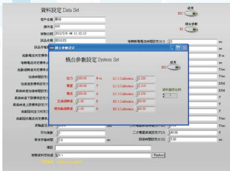
步驟四：測試完成畫面，判定電動機車是否符合標準值，若無符合標準值，調整或檢查，再做測試。
