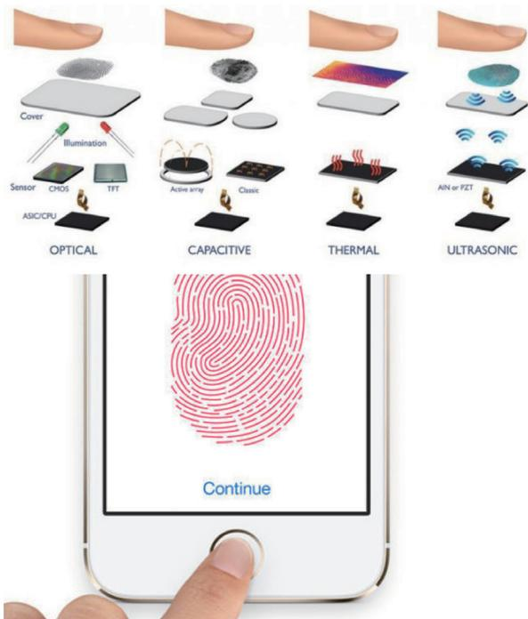
超聲波式屏下指紋傳感器原理：基於超聲波，通過傳感器先向手指表面發射超聲波，並接受回波。利用指紋表面皮膚和空氣之間密度不同構建出一個3D圖像，進而與已經存在於終端上的信息進行對比，以此達到識別指紋的目的。
