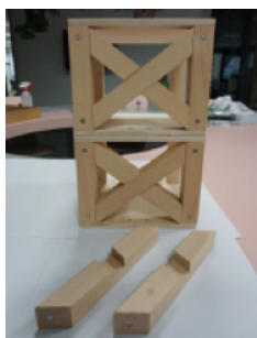
圖 6. 教具實景 (X 型斜撐)
