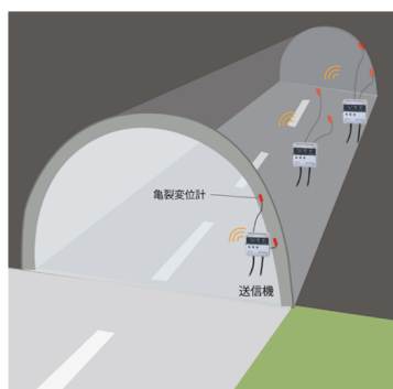
トンネル内多点変位測定
