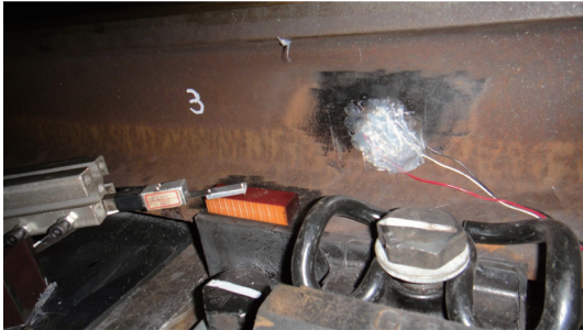
▲ 圖5 內側垂直位移計安裝位置圖
