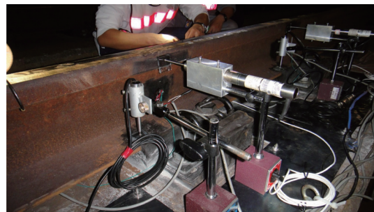
▲ 圖4 側向位移計及外側垂向位移計安裝位置圖
