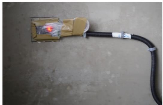
▲ 圖8 各部palert安裝完成後訊號確認 (本專案整理)
