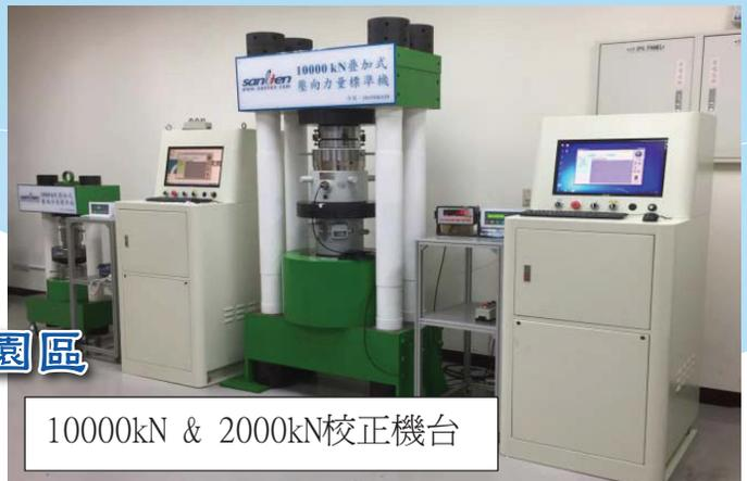
10000kN & 2000kN校正機台
