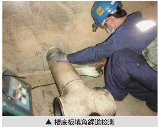
▲ 槽底板填角銲道檢測
