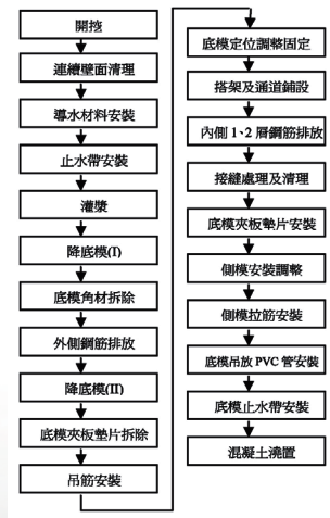
圖 3.3.5 底鈹 Lot1 施工示意圖
